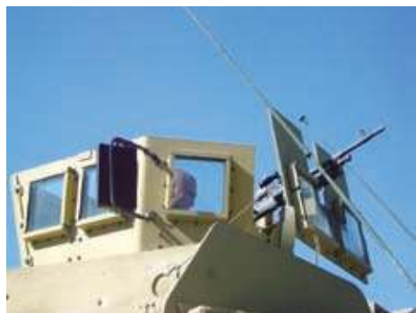
Λεπτομέρεια με πολ/λο τύπου FN-MAG προσαρμοσμένο στον πύργο του οχήματος. (Φωτο Λγός Ευριπίδης Χανιάς)
