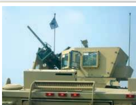
Ο πύργος του οχήματος, στον οποίο έχει τοποθετηθεί πολ/λο 0,50 in M2, κατά τη συνοδεία φάλαγγας στην Καμπούλ.
