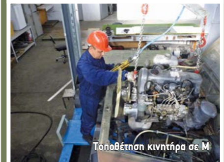
Τοποθέτηση κινητήρα σε ΤΟΜΠ Μ-113
