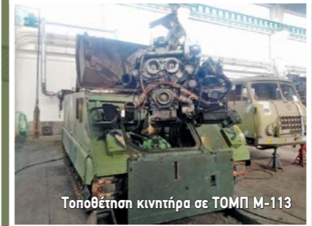
Τοποθέτηση κινητήρα και σασμάν (συγκρότημα) σε 290
