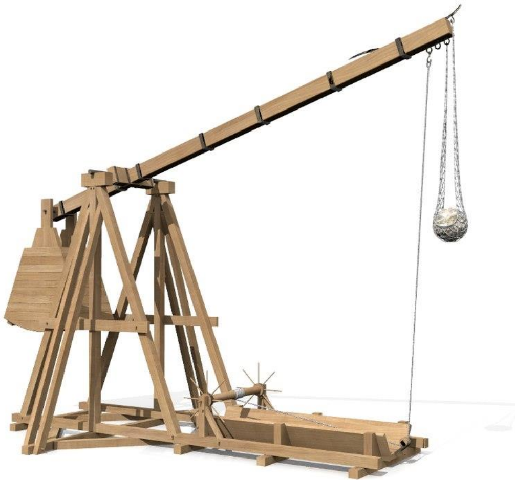
Εικόνα 4: Πετροβόλος μηχανισμός με αντίβαρο
