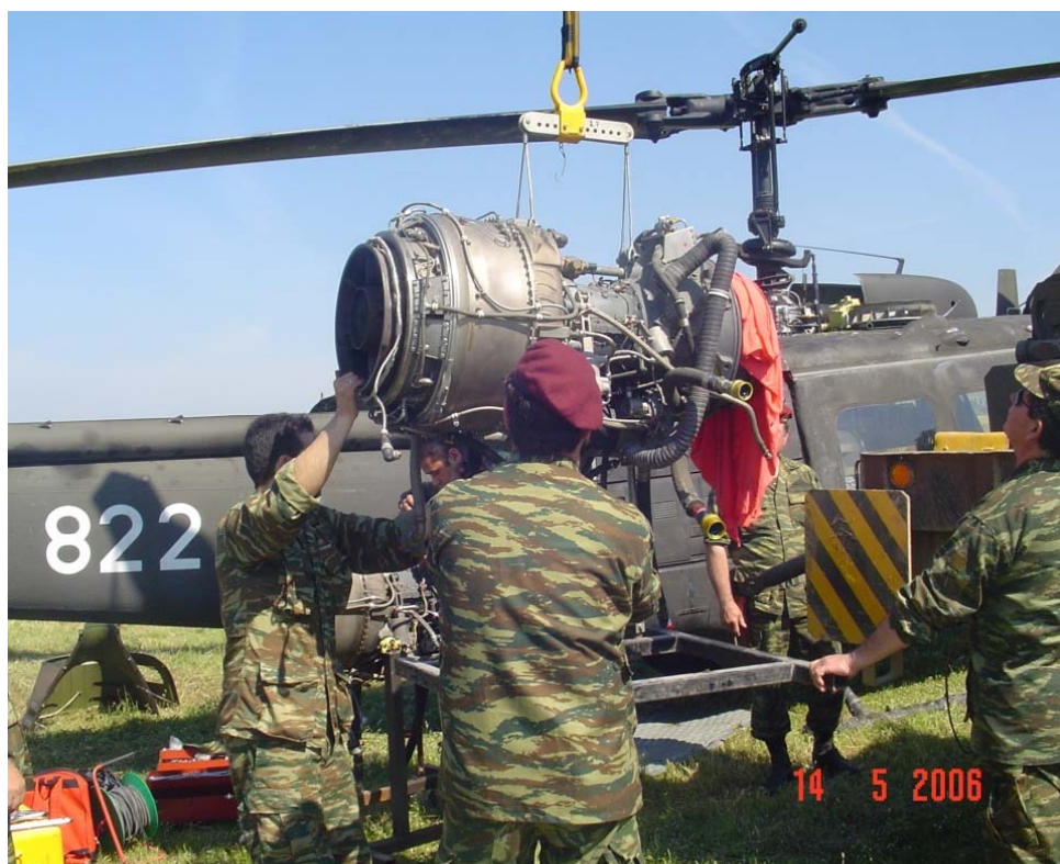
Φωτο. Αλλαγή κινητήρα στο Πεδίο Ασκήσεων
