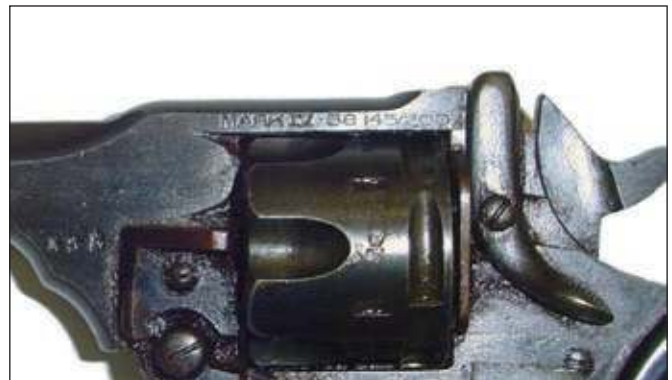
Χαρακτηριστικά στον κλωβό του βυκίου του Webley MkIV: «MARK IV .38 145/200». Πάνω στο βυκίο διακρίνονται και κάποια από τα διακριτικά αποδοχής του όπλου από τον Βρετανικό Στρατό
