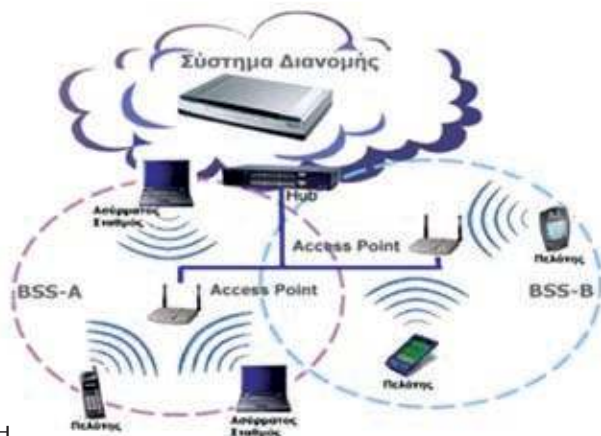
Υλοποίηση ασύρματης δικτύωσης με την τοπολογία Infrastructure Mode
